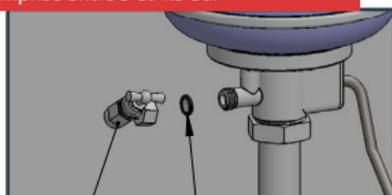
M N Le cône doit être positionné coté mécanisme
