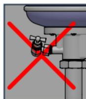
**3** Vous pouvez mettre en eau. Vérifiez qu'il n'y a pas de fuite sur l'arrivée d'eau. Si nécessaire réajustez le serrage de l'écrou du robinet.
